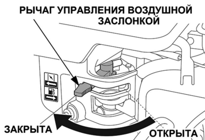
Рис. 12 Воздушная заслонка закрыта
